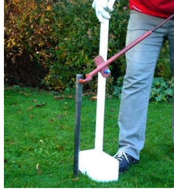
Ziehvorgang des Bohrstocke
